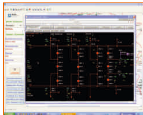
Aplicación de Red Eléctrica para revisar sus instalaciones a distancia.
