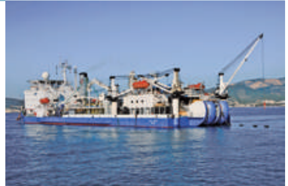
Barco cablero en el tendido de la interconexión Península-Baleares
